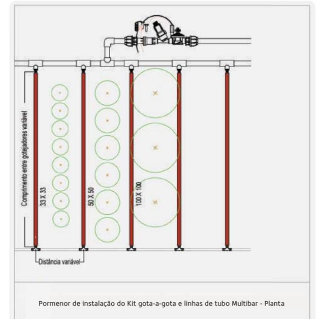
Pormenor de instalação do Kit gota-a-gota e linhas de tubo Multibar - Planta
