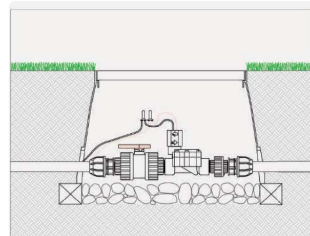
Pormenor de instalação de Caixa com Válvula Electromagnética PGV-100MM-B (1") com válvula Anti-dreno
