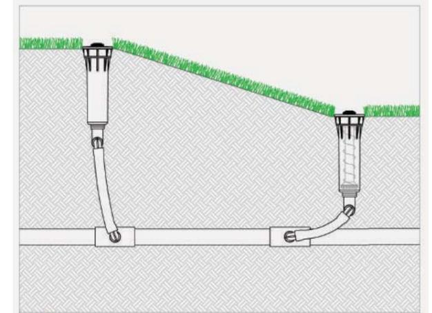
Pormenor de instalação do Corpo Pulverizador PROS 04 com válvula Anti-dreno
